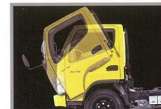
Kabin Jungkit Mudah memeriksa dan memperbaiki mesin.
