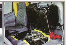
Inspection Lid Berada di bawah jok penumpang sehingga pengecekan mesin lebih mudah.
