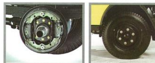
Rem Semakin Pakem Dengan pengembangan rem tromol dan exhaust brake. Baut Roda Ditambah menjadi 6 buah, membuat roda semakin kokoh.
