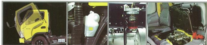
Kabin Jungkit Mudah memeriksa dan memperbaiki mesin. Tangki Radiator Mudah dikontrol Water Separator Mudah diclok Inspection Lid Berada di bawah jok penumpang sehingga pengecekan mesin lebih mudah
